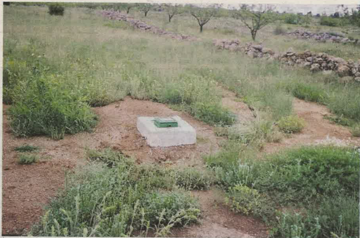
Uno de los piezómetros que forman parte de la red de control de la Confederación del Júcar. / CHJ
