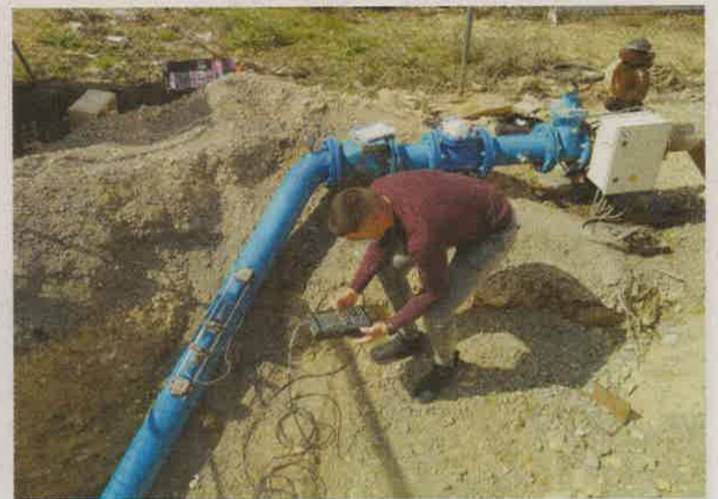
El alumno Vidal Moreno durante la toma de parámetros con un caudalímetro. / A.C.
